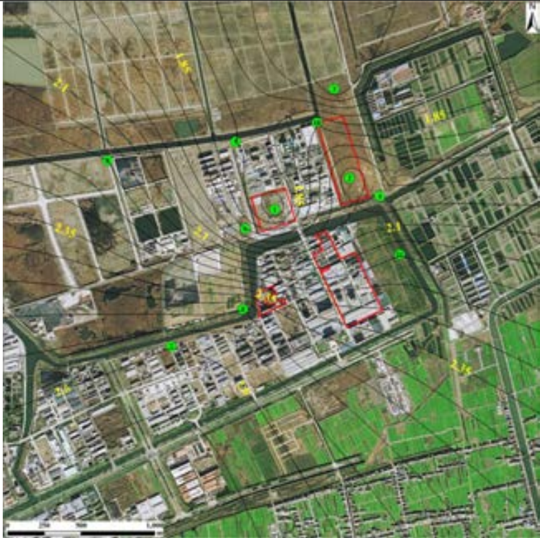
图 6.4.1-4 地下水等水位线图（1#、2#拟建地块）
