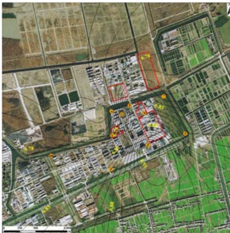
图 6.4.1-5 地下水等水位线图（3#拟建地块）
