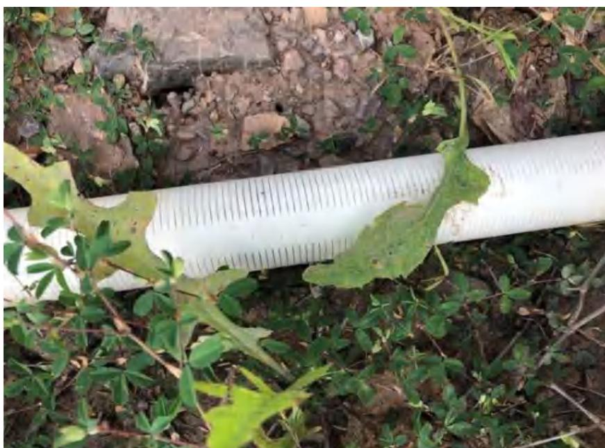
图 8.4-1 滤水管割缝
